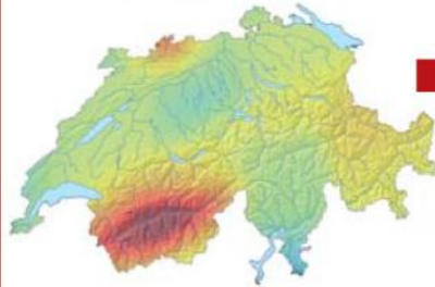
Abb. 2: Erdbebengefährdung in der Schweiz. Rot: hohe Gefährdung, blau/grün: moderate Gefährdung. Quelle: SED
